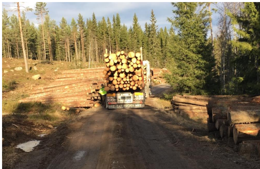
Bilde 10 – Selv en god skogsbilvei bør ikke brukes som driftsveg av lassbærer. Veien får ofte store skader. Velteplasser bør planlegges nøye f.eks. i forbindelse med en opprusting.
