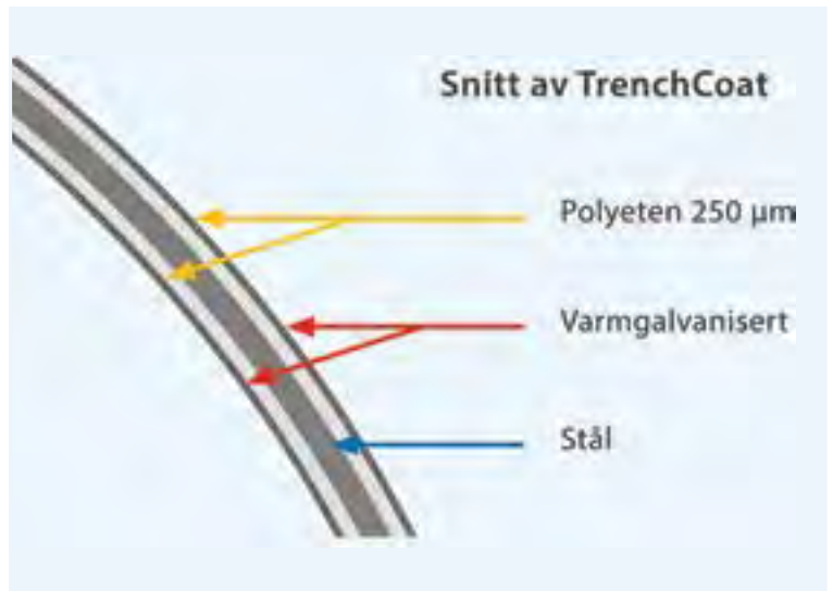
Figur V2.4 Snitt av TrenchCoat, ViaCon
