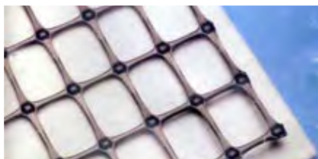
Figur V3.2 Geonett og geotekstil (fiberduk) (Foto: Truls-Erik Johnsrud, Skogkurs)
