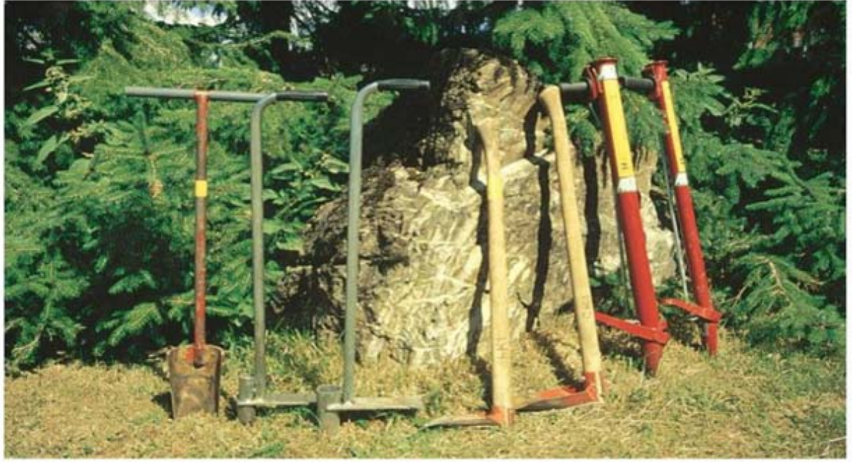
من اليسار إلى اليمين - حفارة الغرس، أنبوب الحفر الصغير والكبير، مجرفة الغرس الصغيرة والكبيرة، أنبوب الغرس الصغير والكبير.
