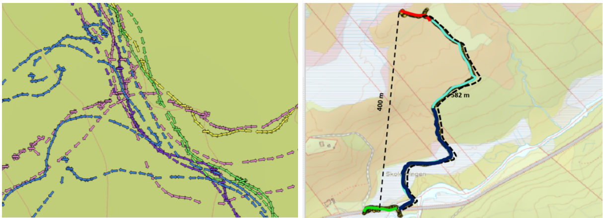
Figur 10. Bruk av lassbærerens GPS-sporlogger data for å beregne kjørehastigheter (venstre) og driftsveiens geometri (høyre).
