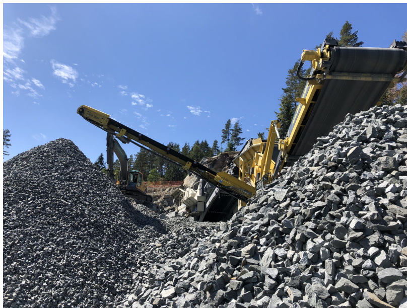
Et mobilt knuseverk i et massetak i Østfold. Legg merke til sikringen i bakgrunnen. Foto: Martin Bråthen, Skogkurs
