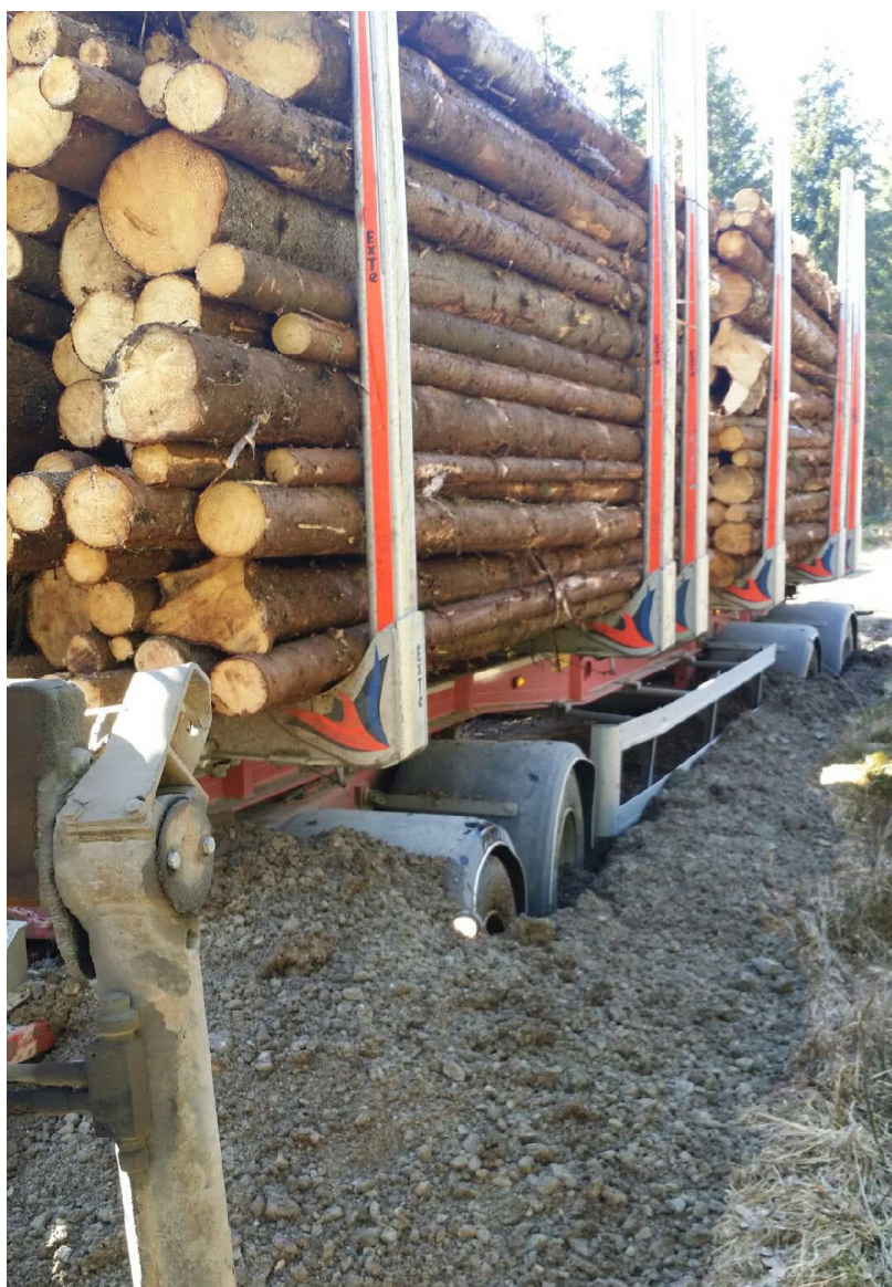
Fastkjørt - dårlig bæreevne. Foto: Dag Minge
