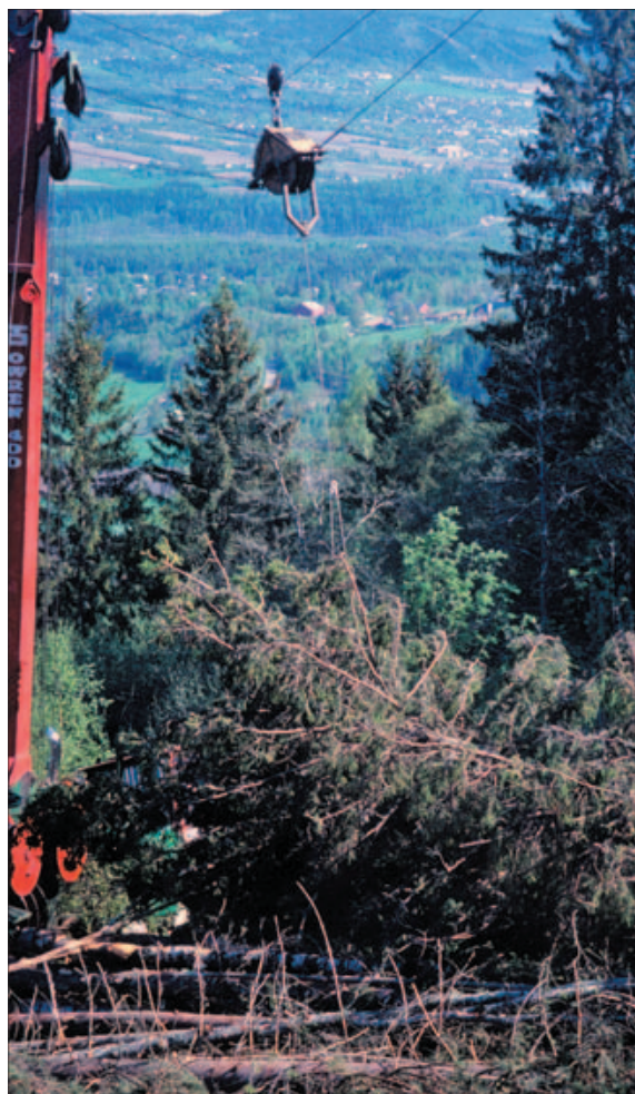
Owren tredelt trommelkatt på løpende bærekabel. TEJ
