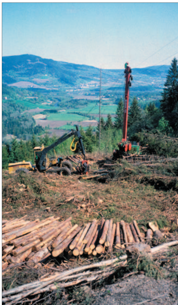
Owren 400, kabelkran med løpende bærekabel. TEJ
