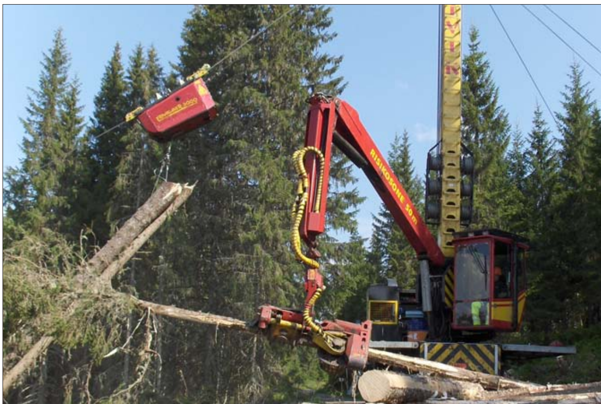
Konrads, Woody 60. Hogstaggregat fra Østerrike hvor matevalsene kan svinges opp og kvisteknivene brukes til tømmergrip. Meget godt egnet for opparbeiding og stabling av tømmer på standplass. NOK
