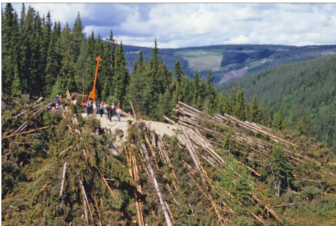
Vinsjing av heltre for seinere opparbeiding med hogstmaskin. Owren Variovinsj. TEJ
