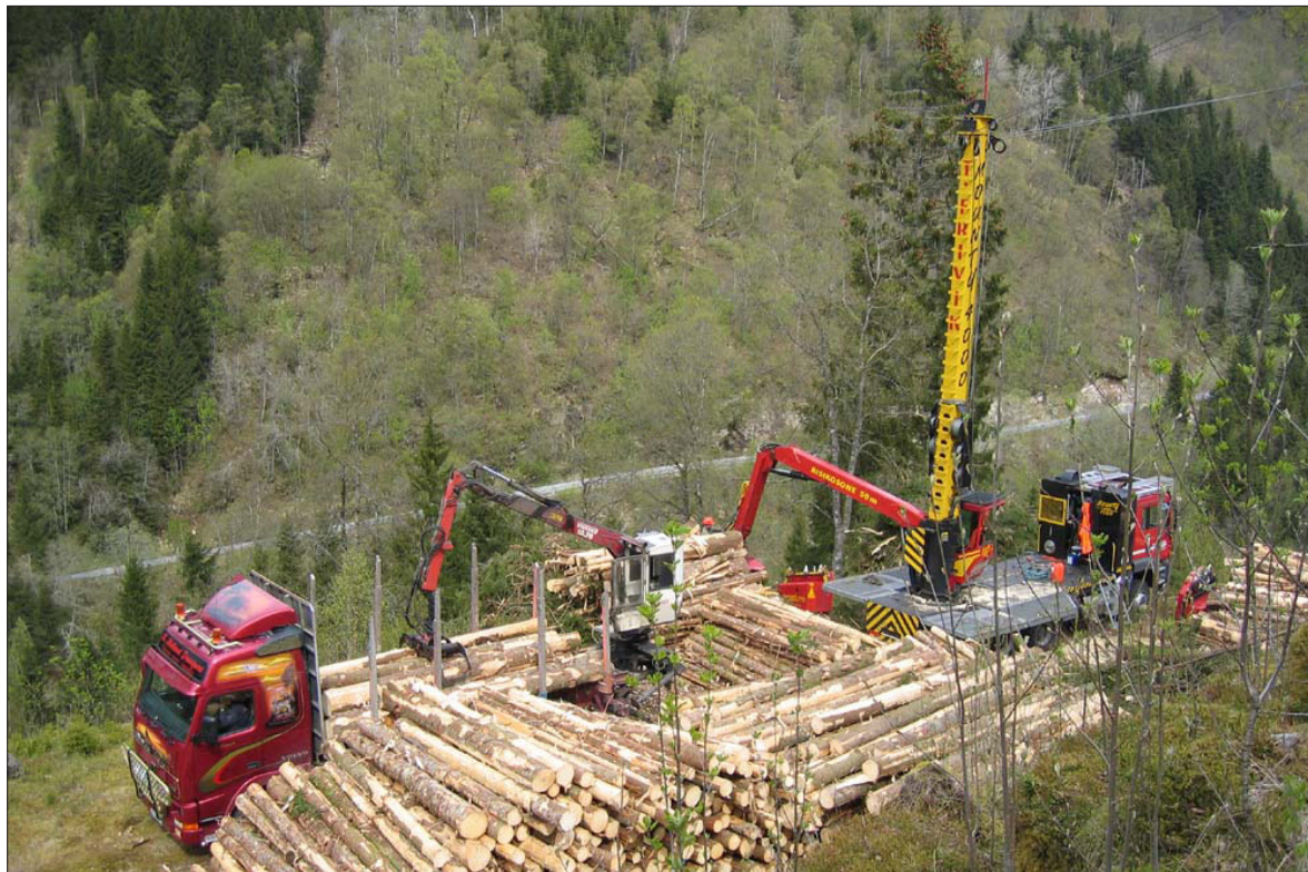
Bilvegen som standplass. Lastebilmontert Mouny 4000 kabelkran med Woody 50 hogstaggregat. TF
